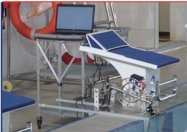
圖一 拉線式速度監控設備的外形及其架設
